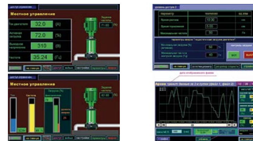
Рисунок 7.2 – Интерфейс программы мониторинга параметров и управления электронасосным агрегатом
